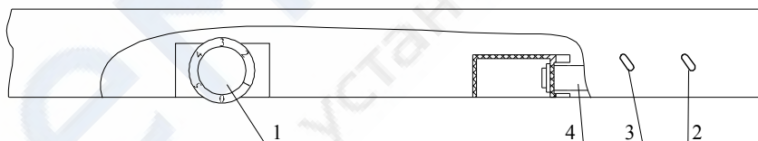
Рис.2. Схема расположения приборов управления и сигнализации 1 — ручка терморегулятора; 2 — зеленая индикаторная лампа; 3 — желтая индикаторная лампа; 4 — переключатель
